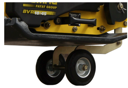
Transport sécurisé Poignées de transport (en série) et roues de transport (en option)
